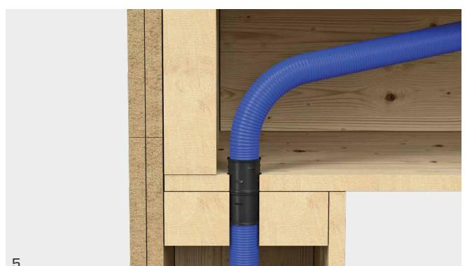
1 Bohrung im Holz. Die Mindeststärke des zu verwendenden Materials beträgt 15 mm.
