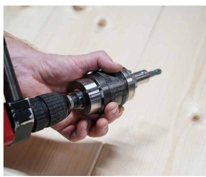
Die äußere Einschraubhülse drehen, um den TORQUE LIMITER zurückzusetzen.
