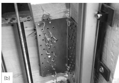
Próbki po zakończeniu badań cyklicznych: rozciąganie (a), ścinanie (b) i 45^\circ (c) (gwoździowanie częściowe).
