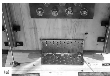
Próbki po zakończeniu badań cyklicznych: rozciąganie (a), ścinanie (b) i 45^\circ (c) (gwoździowanie częściowe).
