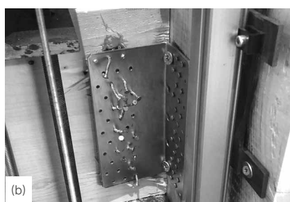
Amostras no final dos testes cíclicos: tração (a), corte (b) e 45° (c) (fixação parcial).
