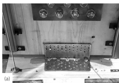
Amostras no final dos testes cíclicos: tração (a), corte (b) e 45° (c) (fixação parcial).
