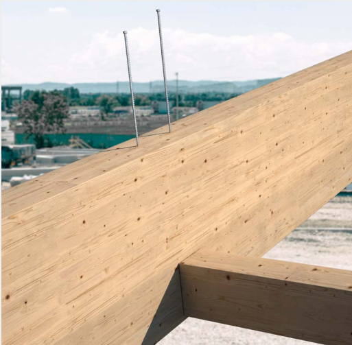
^ 并排 CLT 楼板的极高刚度的连接。 45°双倾角的应用，非常适合通过 JIG VGZ 模板而实现。 由于主次梁连接所致的悬挂荷载对纹理的正交 加固。 ^
