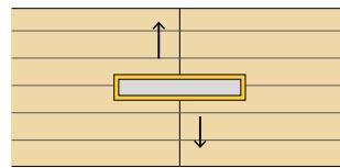
Para barras encoladas perpendicularmente a la fibra, la resistencia al recalcado se puede aumentar hasta un 25 %.
